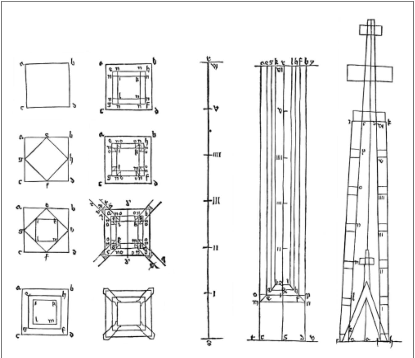
Fig. 1 Steps in the geometrical construction of a pinnacle, after Matthäus Roriczer, *Das Büchlein von der Fialen Gerechtigkeit*, 1486.
